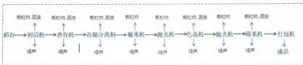
图 2-2 大米加工生产线工艺流程及产污环节
